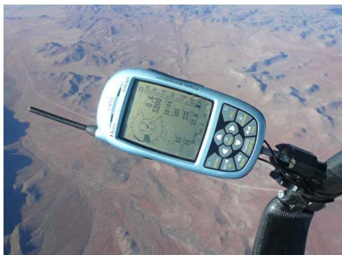
Poiché l'intensità del segnale ricevuto dai satelliti è solo ~1/1000 di quello delle radio portatili, per non alterare la qualità della ricezione, allontanate ricetrasmittenti, telefonini e altri apparecchi elettronici dal vostro strumento. Il numero dei satelliti in ricezione viene visualizzato nella parte superiore destra dell'indicatore a barra. Più lunga è la barra, migliore è la qualità della ricezione.
