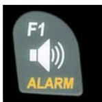
In volo tramite una pressione prolungata del tasto **Alarm** → **Stall** è possibile attivare o disattivare il segnale acustico di allarme di stallo utilizzando il tasto F1.
