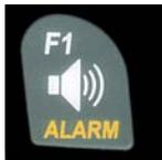
In volo tramite una pressione prolungata del tasto **Alarm** → **Sink** è possibile attivare o disattivare il segnale acustico di discesa utilizzando il tasto F1.
