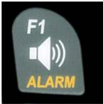
El punto de inicio de la acústica de descenso puede ajustarse como el de ascenso. El umbral puede fijarse con el uso de las teclas arriba▲y abajo▼entre -0,1 y -20,0m.
