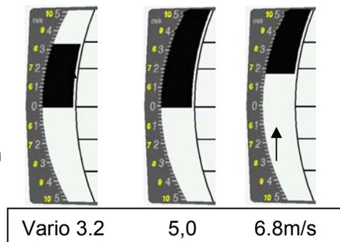
La escala del vario analógico es de 0,2 m/s ¡en ambos rangos! (Patente Flytec AG). El rango de la primera escala va de 0 hasta +/- 5m/s. Después cambia automáticamente a la segunda escala, que va de 5 a 10m/seg. Esta aparece en blanco sobre un fondo negro.
