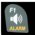
Con el uso de la tecla **Nivel de audio** se ajuste el volumen del altavoz integrado. Posee 5 niveles, desde sin sonido hasta el máximo volumen. El valor seleccionado se muestra con un símbolo de audio y se confirma con un pitido corto o doble. Los niveles de audio son:
