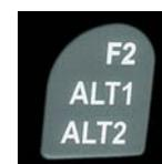
Die Höhenanzeige **Alt1** zeigt grundsätzlich die absolute Druckhöhe über dem Meeresspiegel an. Der Höhenmesser ALT1 wird beim Einschalten vom Instrument automatisch mit der GPS Höhe abgeglichen. Nach dem Einschalten blinkt die Anzeige solange, bis der GPS Empfänger eine genaue Höhe zum Einstellen berechnet hat.
