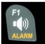
Im Flug kann der Stall Alarm mit einem Langdruck auf die **Taste Alarm** → Stall mit den Tasten F1 / F2 ein- oder ausgeschaltet werden.
