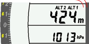
Si l'**altimètre 2** est réglé en altimètre **absolu** il est ajusté de la **même manière que ALT1**. Néanmoins, il est couplé avec ALT2 et de ce fait toute **modification** pour **ALT1** sera **transmise à ALT2** et vice versa.
