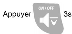
Une pression de trois secondes sur la touche Sink permet d'accéder au mode de réglage de l'alarme de descente.
